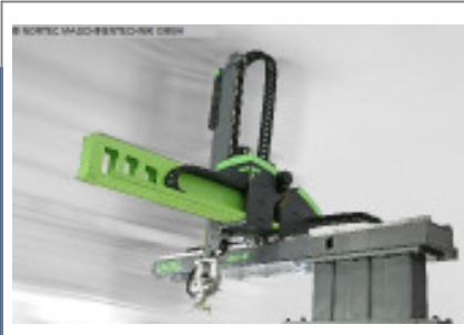
Linearroboter ENGEL VIPER 40 regular stand alone Nr. 2355 Baujahr 2012 X-Achse Entform 700 mm Y-Achse Vertika 1.900 mm Z-Achse Quertra 4.280 mm
