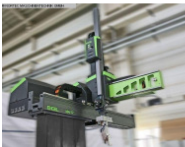
Linearroboter ENGEL VIPER 12 regular stand alone Nr. 2386 Baujahr 2012 X-Achse Entform 600 mm Y-Achse Vertika 1.200 mm Z-Achse Quertra 2.240 mm
