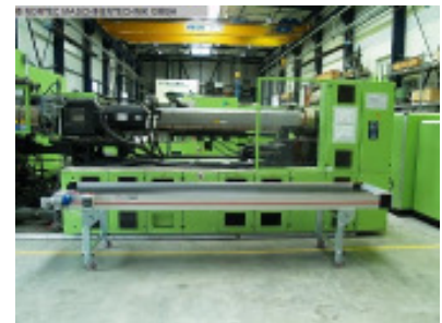
Horizontal-Förderband NORTEC Horizontalfoerderband 3000x800 Nr. 2429 Baujahr 2012 Gurtlänge 3000 mm Gurtbreite 750 mm Gesamtbreite 805 mm
