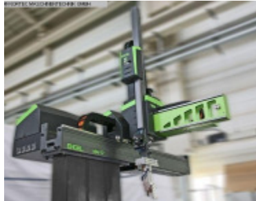
Linearroboter ENGEL VIPER 12 regular stand alone Nr. 2381 Baujahr 2012 X-Achse Entform 600 mm Y-Achse Vertika 1.200 mm Z-Achse Quertra 2.240 mm
